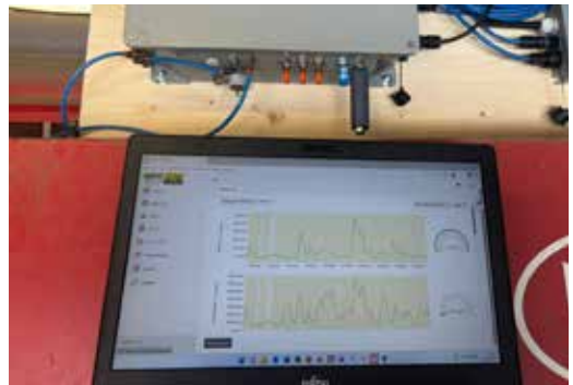
Mithilfe eines Sniffers werden die Methanmessungen während dem Melken in AMS-Anlagen durchgeführt.
